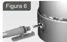
conector rápido, por medio del cual se une al conector hembra en la parte posterior del prefiltro (Figura 6). En las instalaciones bajo mesada, la manguera en sus diversos tramos vincula la conexión de agua fría con la **Grifería PSA BM** y con el equipo.
